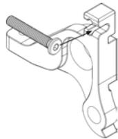
**Étape 3 :** Faites glisser le coulisseau du côté chaîne et la vis de tension en position sur la patte du côté chaîne. Vissez la vis de tension jusqu'à ce que les filets de la douille du coulisseau soient positionnés au-dessus de la fente de la douille.
